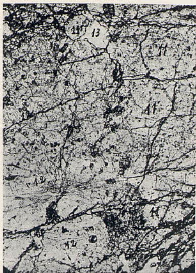
FIG. 1. Granatita del Moli Vell. L. ord. 10 d.; 11, granate; 12, vesubiana; 13, granos de epidota y diopsido
