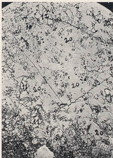
FIG. 3. Granatita compleja del Moli Vell. L. ord. 10 d.; 10, calcita; 11, granate; 12, vesubiana; 20, prehenita
