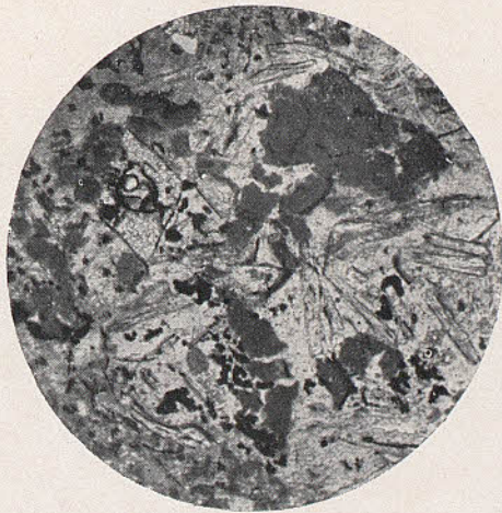
Fig. 9. — Toba traquítica. L. ord. 25 d, igual prep. Microfot. M. San Miguel. Cristales de dolomía, masas de clorita, microlitos de sanidina.
