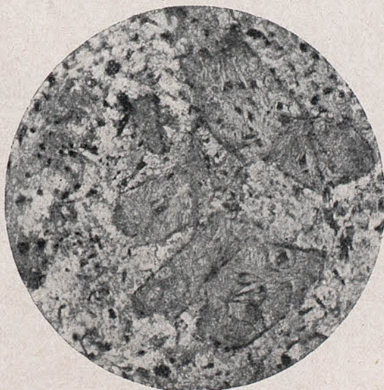
Fig. 10.—Orto-anfibolita diabásica de Camarena. L. ord. 40 d. prep. n.º 343 col. M.º Cien. Nat. de Barcelona. 2 feldespato. 5 actinota. 11 magnetita. Microfot. M. San Miguel.
