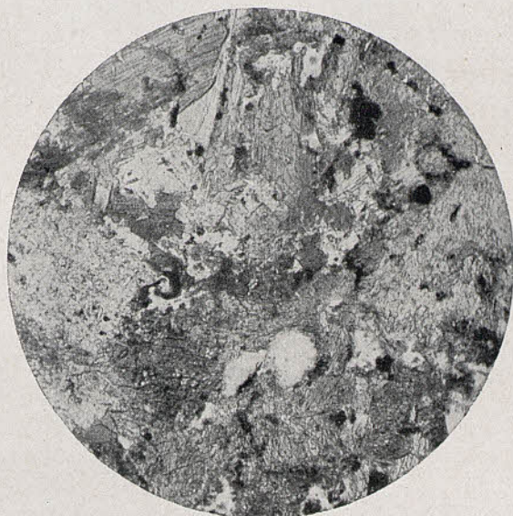
Fig. 1.—Diabasa albítica de Camarena. L. ord. 40 d. prep. n.º 338 col. M.º Cien. Nat. de Barcelona. 2 feldespato alterado. 5 uralita horbléndica. 6 dialaga. 11 magnetita. Microfot. M. San Miguel.
