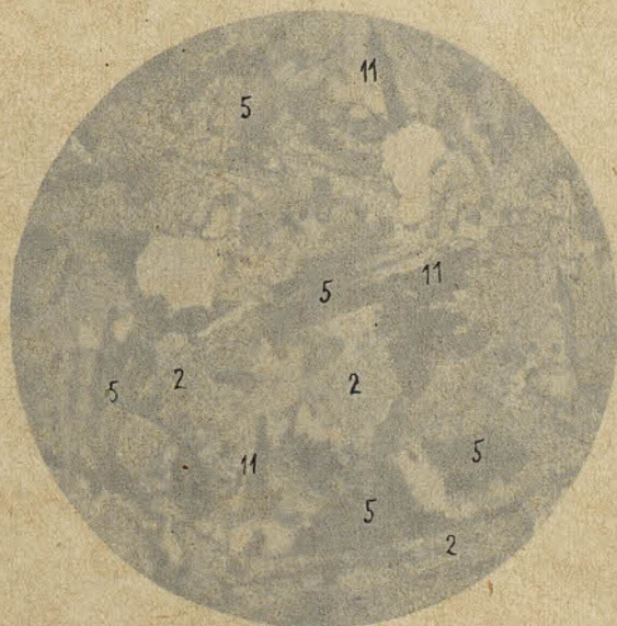
Fig. 8.—Diabasa uralítica de Camarena. L. ord. 40 d, prep. n.º 342 col. M. Cien. Nat. de Barcelona. 2 plagioclasa alterada. 5 uralita. 11 magnetita. Micro- for. M. San Miguel.
