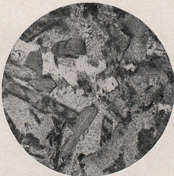
Fig. 12.—Diabasa cuarcífera de Orihuela. L. ord. 40 d. prep. n.° 350 col. M.° Cien. Nat. de Barcelona. 1 cuarzo. 2 feldespato alterado. 5 uralita actinótica. 11 ilmenita. P. micropegmatita. Microfot. M. San Miguel.
