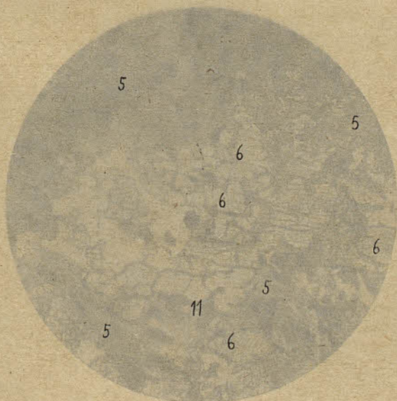
Fig. 2.—Diabasa albitica de Camarena. L. ord. 40 d. prep. n.° 138 col. M. Cien. Nat. de Barcelona. 5 horblenda, 6 dialaga, 11 magnetita. Microfot. M. San Miguel.
