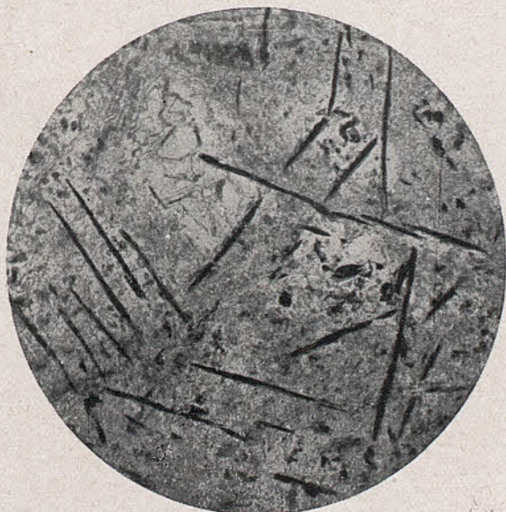
Fig. 6.—Diabasa de Camarena. L. ord. 40 d. prep. n.º 341 col. M.º Cien. Nat. de Barcelona. 1 cuarzo. 2 plagioclasa. 11 magnetita. 14 calcita. Microfot. M. San Miguel.
