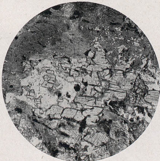
Fig. 2.—Diabasa albítica de Camarena. L. ord. 40 d. prep. n.º 338 col. M.º Cien. Nat. de Barcelona. 5 horblenda. 6 dialaga. 11 magnetita. Microfot. M. San Miguel.
